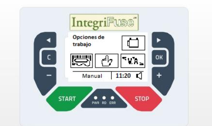
Mediante las flechas < y > elegir la opción para introducir manualmente los valores de tensión de soldadura y del tiempo de duración del ciclo de fusión. Usando la flechas < y > elegir el tipo de valor (Volts o Segundos) que se debe insertar:
