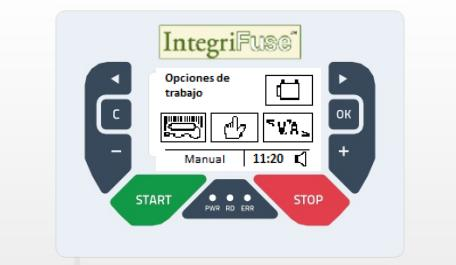
Mediante las flechas < y > elegir la opción para introducir manualmente el código numérico de soldadura del accesorio y en la pantalla aparecerá:
