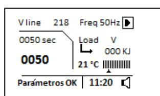
El transcurso del tiempo está indicado por el número grande. La escala graduada es un indicador de la temperatura ambiente. En cuanto el ciclo se complete, en la pantalla aparecerá siguiente imagen y hay que pulsar **OK** para interrumpir el sonido que indica la fin del ciclo de soldadura:
